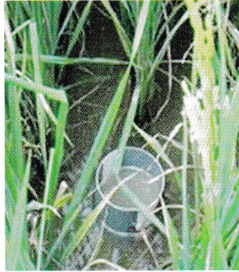
চিত্র: ধানের জমিতে পানির অবস্থা পর্যবেক্ষণের জন্য ছিদ্রযুক্ত প্লাস্টিক পাইপ
