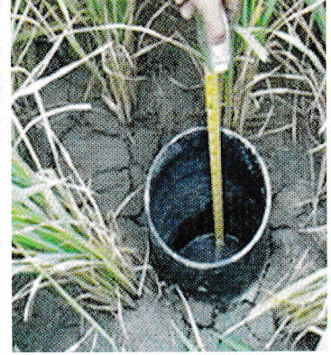
চিত্র: ধানের জমিতে পানির অবস্থা পর্যবেক্ষণের জন্য ছিদ্রযুক্ত প্লাস্টিক পাইপ
